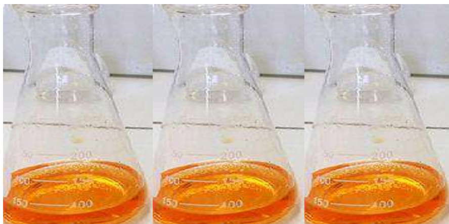
Figura 5: Titulação com \text{H}_2\text{SO}_4 0,02 Mol/L.
