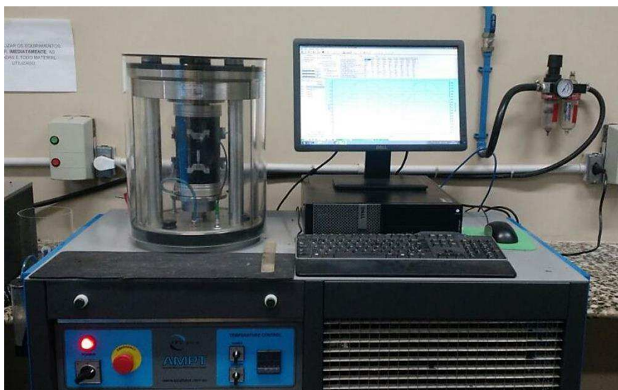
Figura 31 – Realização do ensaio de módulo dinâmico na AMPT.
