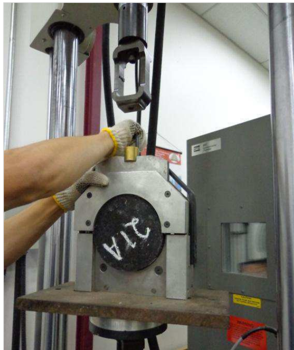
Figura 20 – Dispositivo do ensaio Leutner Shear Test.
