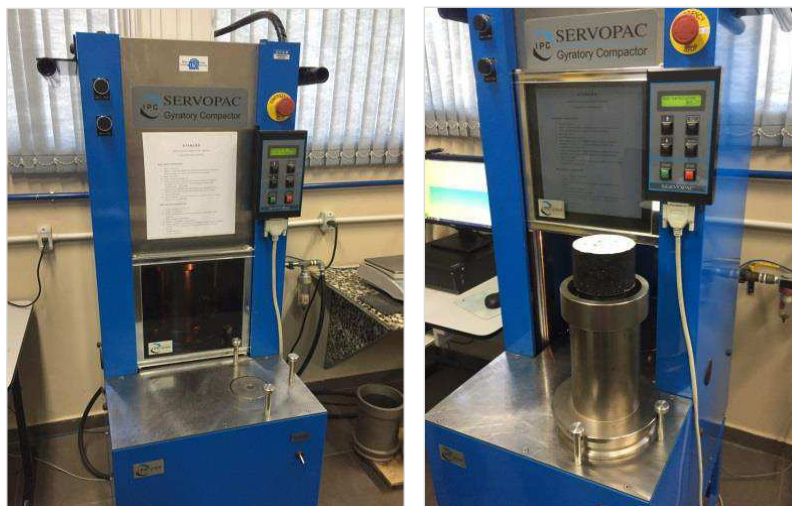
Figura 7 – CGS: a) em operação e b) no momento da retirada do corpo de prova.
