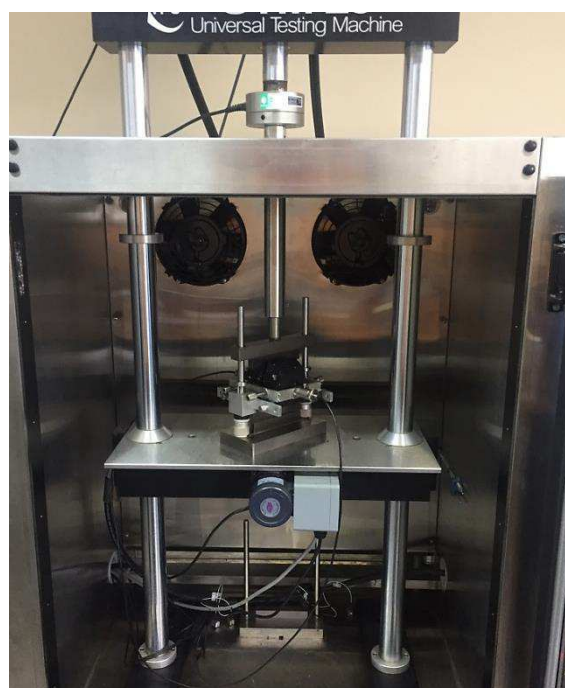
Figura 33 – Ensaio de vida de fadiga realizado na prensa UTM.
