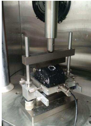
Figura 30 – Realização do ensaio para determinar o módulo de resiliência.
