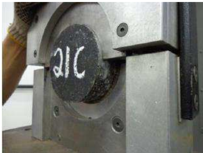
Figura 34 – Dispositivo do Ensaio Leutner.
