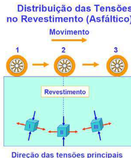
Figura 9 – Distribuição de tensões geradas por carga em movimento.
