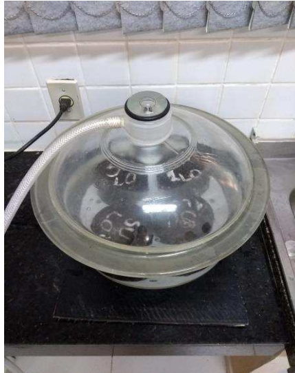
Figura 29 – Processo de saturação à vácuo dos corpos de prova.
