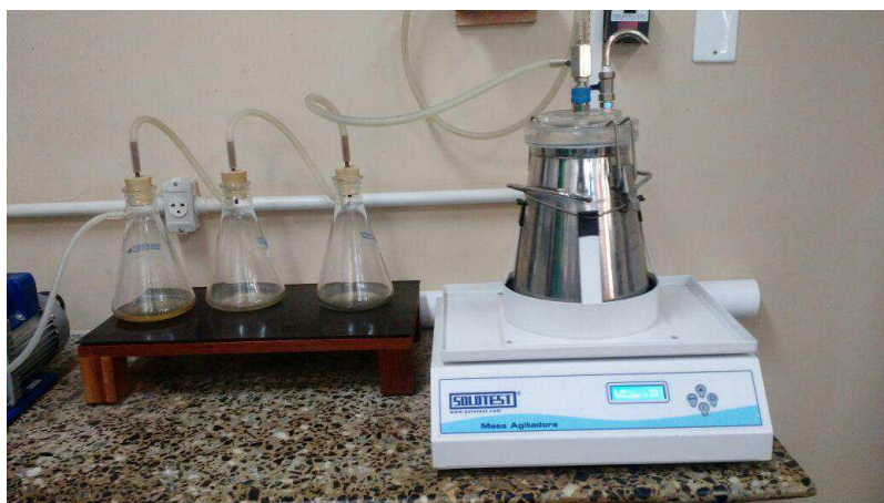
Figura 28 – Aparelhagem utilizada no Rice Test.
