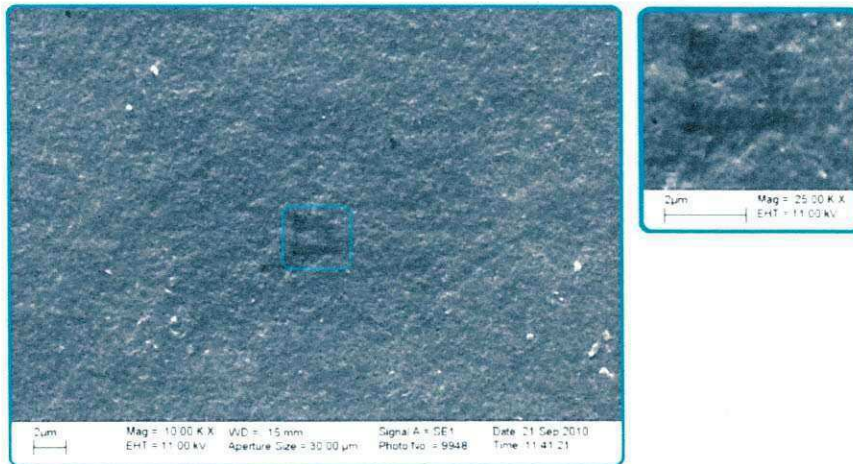
Figura 30. Fotomicrografias de MEV obtidas na superfície de topo da membrana P1-Q (PA6 obtida a quente)
