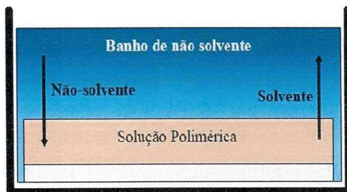
Figura 9. Esquema de troca solvente/não-solvente no processo de preparação de membranas por inversão de fase úmida (Fonte: Habert et al., 2006).
