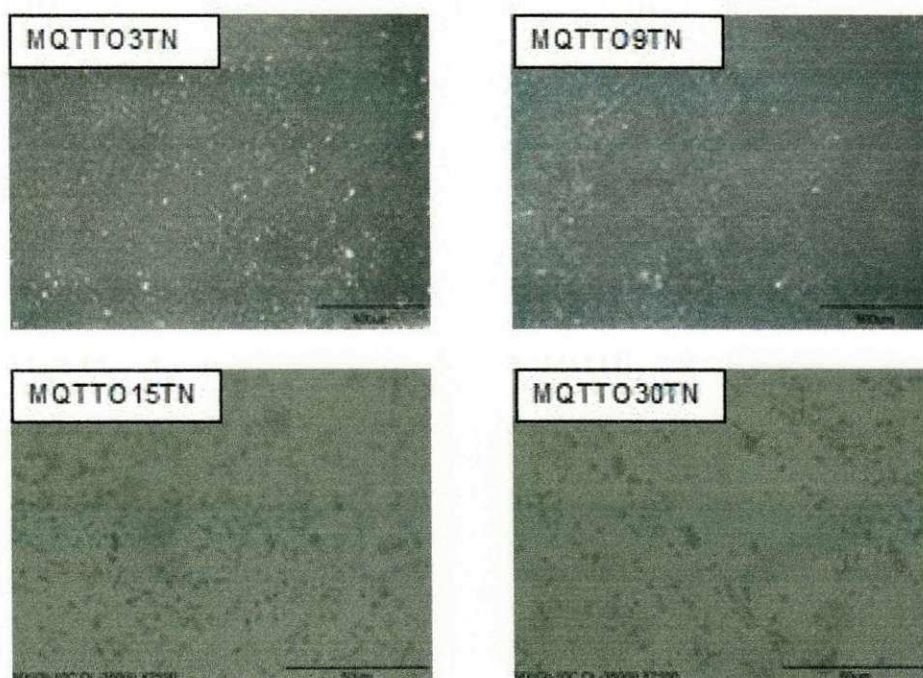
Figura 5.3 - Imagens obtidas por microscopia óptica das membranas de quitosana com 3%; 9%; 12%; 15% e 30% de TTO na presença do agente tensoativo Tween 20 e neutralizadas (MQTTO3TN; MQTTO9TN; MQTTO12TN; MQTTO15TN e MQTTO30TN).
