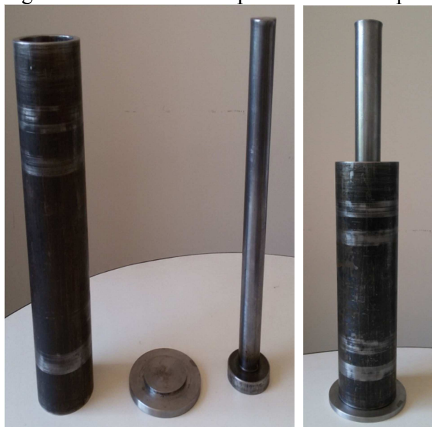
Figura 1- Forma utilizada para forma os briquetes
