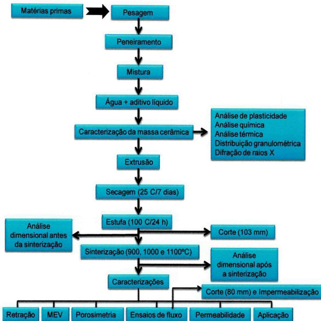
Figura 4.1. Fluxograma da obtenção e caracterização das membranas cerâmicas.
