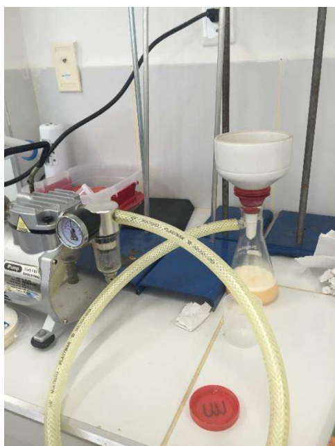
Realização de filtração – Sistema montado com bomba de filtração a vácuo, funil de Buchner e kitassato.
