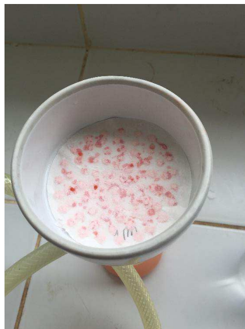
Final de filtração. Filtro com massa da formulação retida, demonstrando ponto e tipo de fase oleosa utilizada (1M, ponto 1/óleo de maracujá).
