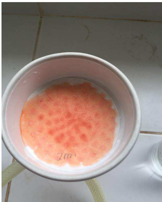
Final de filtração. Filtro com massa da formulação retida, demonstrando ponto e tipo de fase oleosa utilizada (2M, ponto 2/óleo de maracujá).
