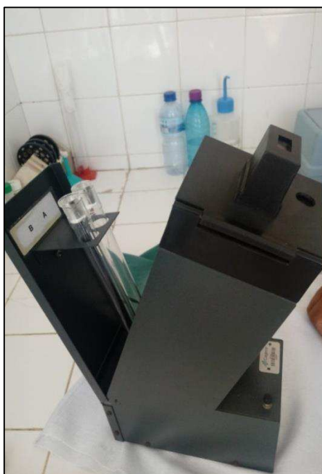
Imagem 11: Colorímetro utilizado para realização da análise da cor da água
