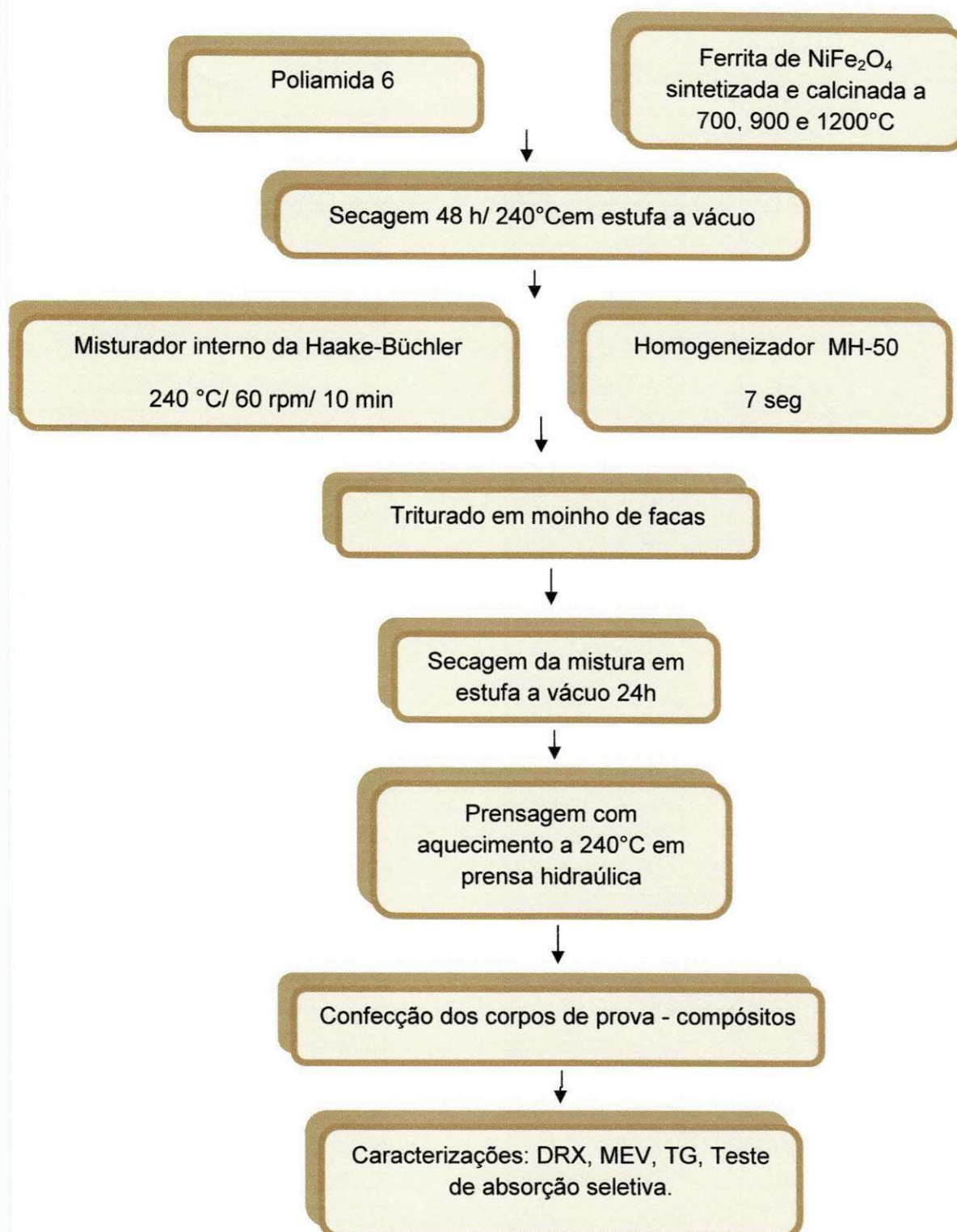
Figura 13: Fluxograma da metodologia da preparação dos compósitos de poliamida 6/ferrita de níquel (NiFe 2 O 4 ).
