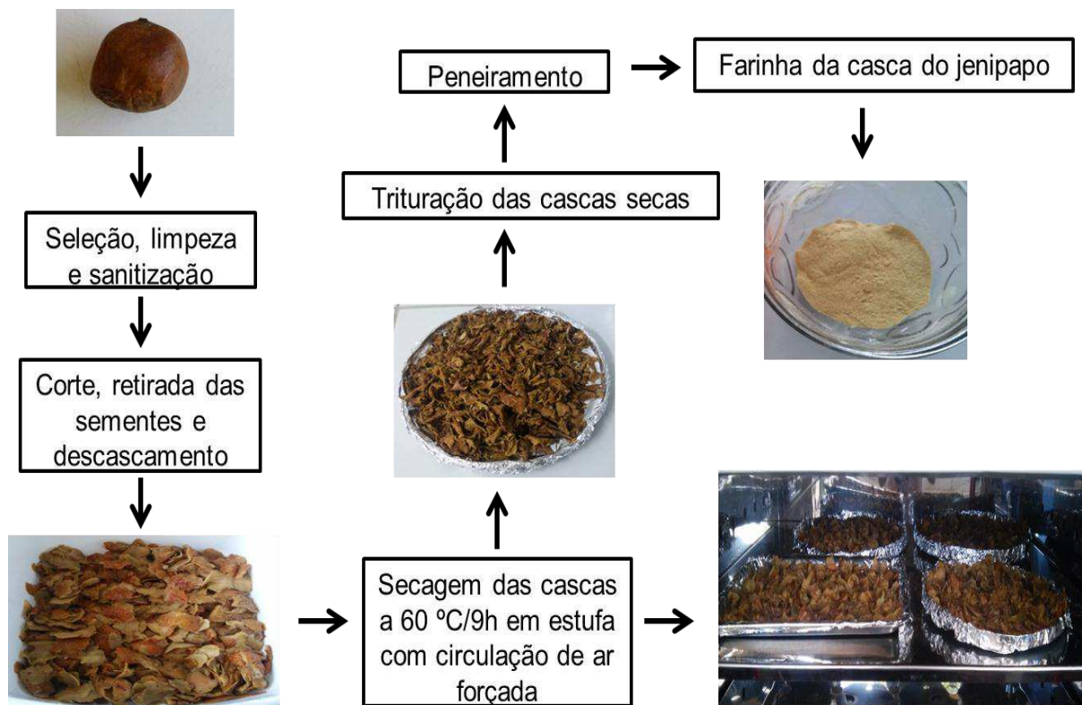
Figura 6 - Fluxograma de processamento da farinha da casca do jenipapo.
