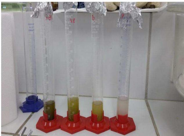
Figura 4 – Determinação do extrato etéreo
