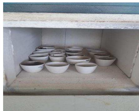
Figura 3- incineração das amostras
