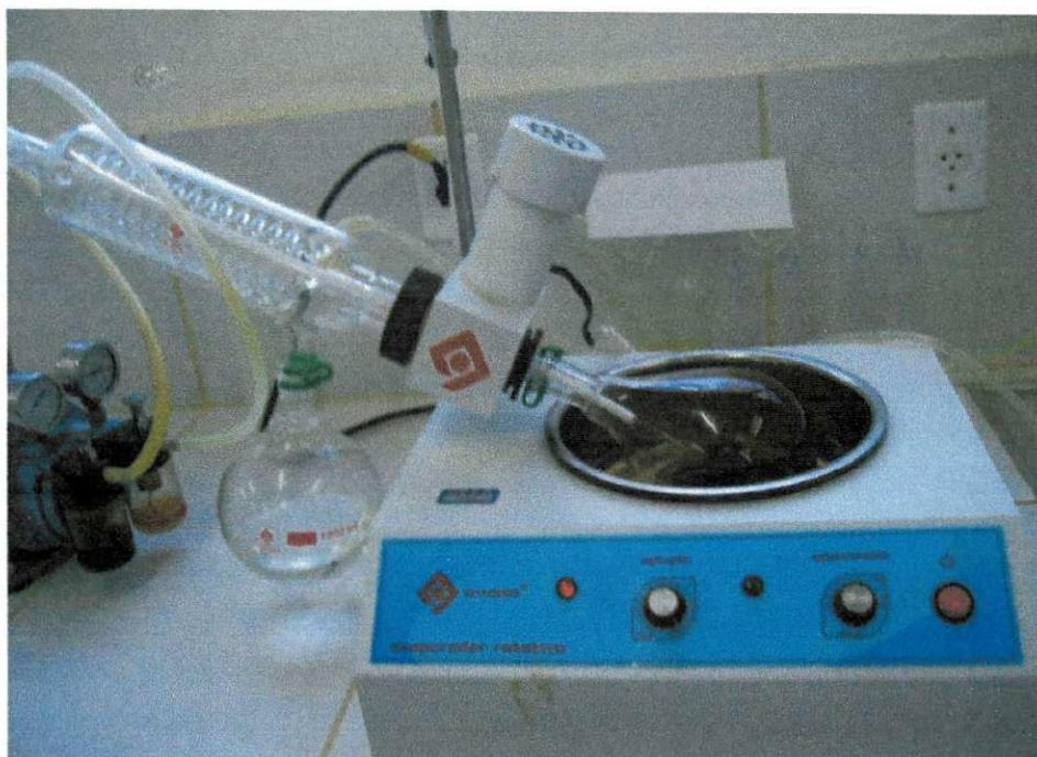
**Figura 3.5** Evaporador rotativo
