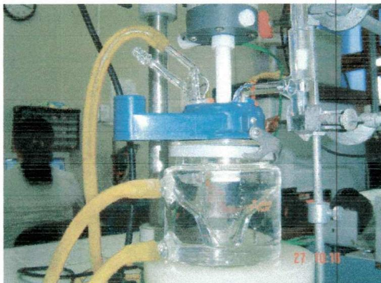
Figura 05 - Célula de vidro com três compartimentos
