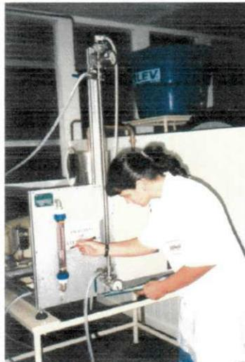
Figura 12 - Protótipo de Ultrafiltração
