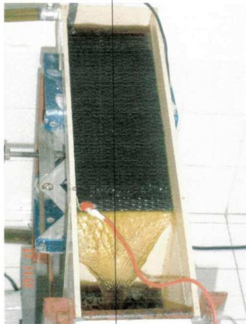
Figura 10 - Ânodo durante o processo eletroquímico
