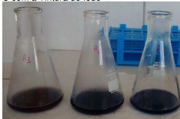
Figura 9: Ponto final da reação da vitamina C com a Tintura de Iodo
