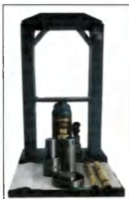
**Figura 5.** Prensa hidráulica manual para extração de torta e óleo de mamona
