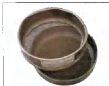
**Figura 8.** Peneira com granulometria de 2 mm
