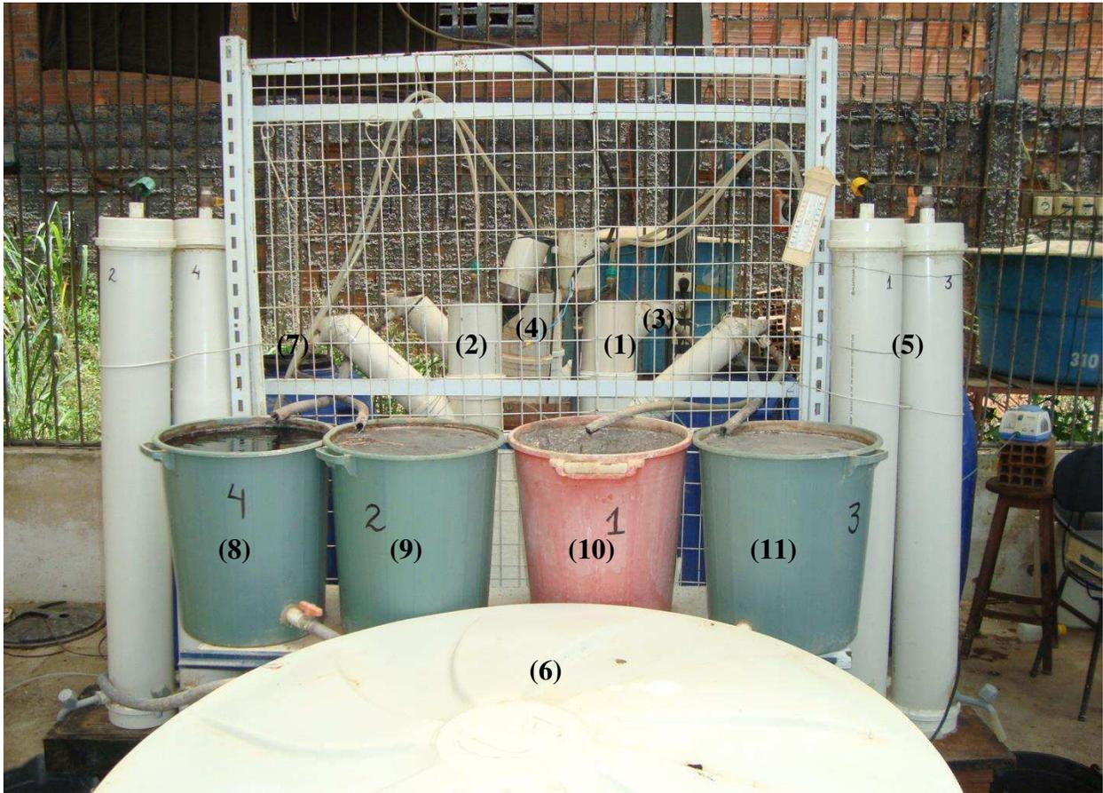
**Figura 4.3:** Fotografia do sistema monitorado: (1,2,3 e 4) respectivos reatores UASB R1, R2, R3 e R4, (5) *Mariotti* com  $\text{Na}_2\text{CO}_3$  3%, (6) Caixa de armazenamento do recirculado (Efluentes), (7) caixas de armazenamento do vinhoto afluente, (8,9,10 e 11) baldes de coleta e armazenamento do efluente.
