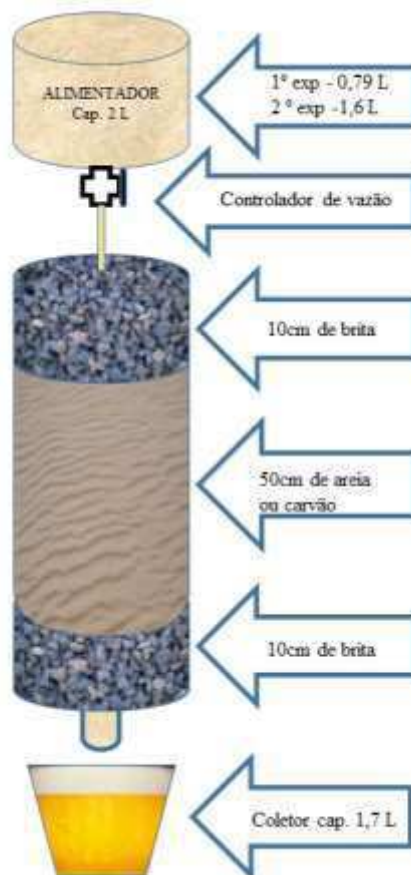
Figura 15 – Esquema de montagem das unidades de percolação.
