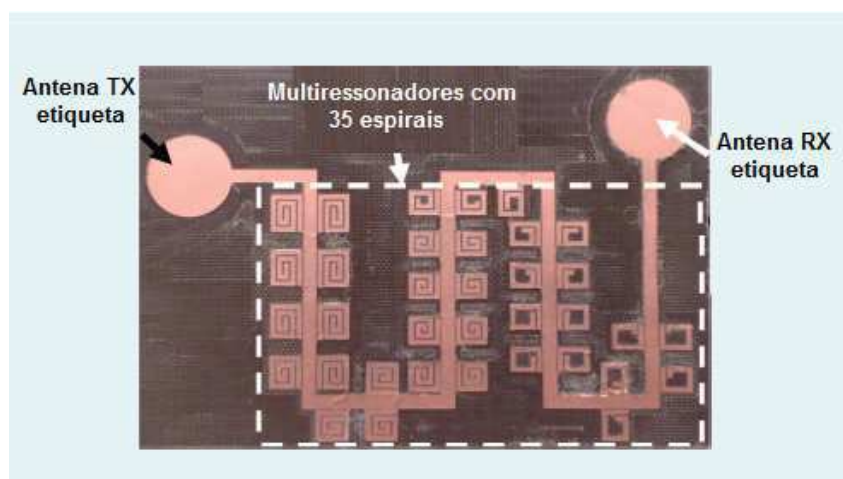
Figura 2.15 Foto de uma etiqueta que utiliza multiressonadores para assinatura espectral com 35 bits codificados. Fonte: [7] modificada.
