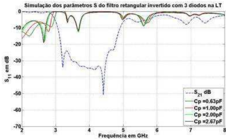
Figura 66 – Resposta em frequência do modelo 3 para o filtro retangular invertido.
