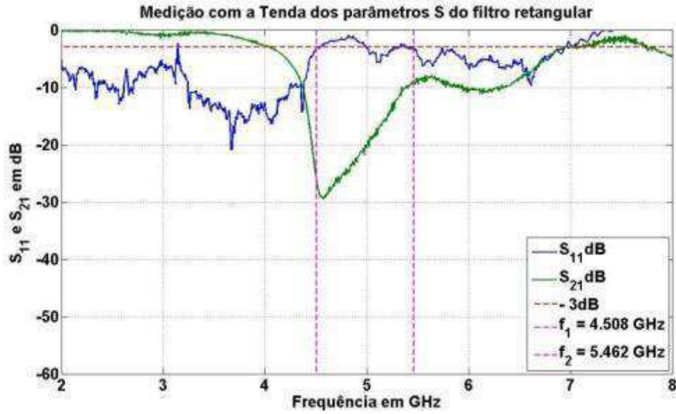
Figura 37 – S_{11} e S_{21} do filtro da configuração 02 protegido de EMI irradiadas e conduzidas.
