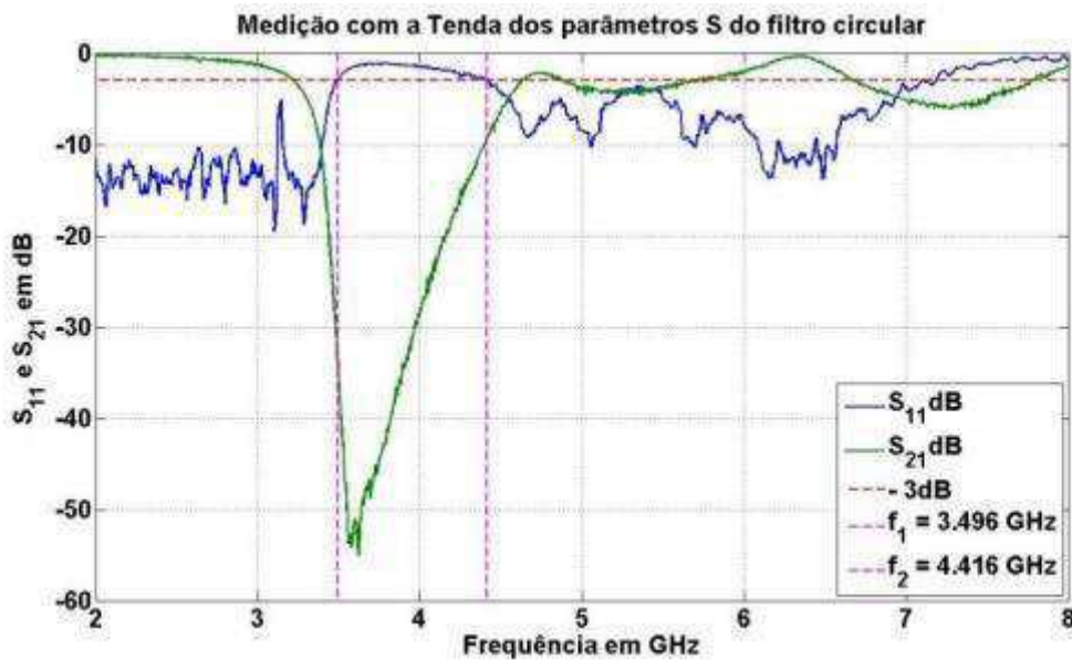
Figura 36 – S_{11} e S_{21} do filtro da configuração 01 protegido de EMI irradiadas e conduzidas.
