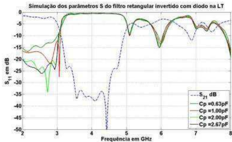
Figura 59 – Resposta em frequência do modelo 2 para o filtro retangular invertido.
