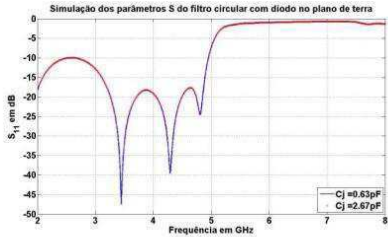
Figura 52 – Resposta em frequência do modelo 1 para o filtro circular.
