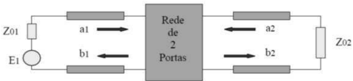
Figura 8 – Rede de duas portas com fonte de tensão na porta (1) e impedância casada na porta (2).
