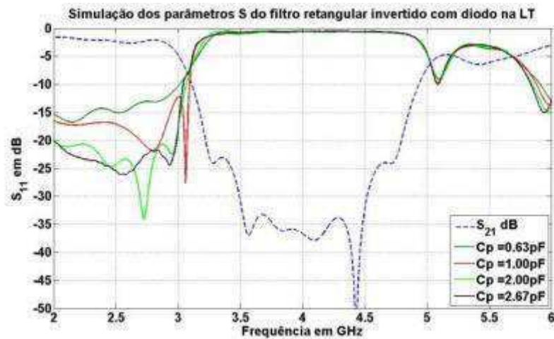
Figura 61 – Resposta em frequência do modelo 2 para o filtro retangular em detalhe.
