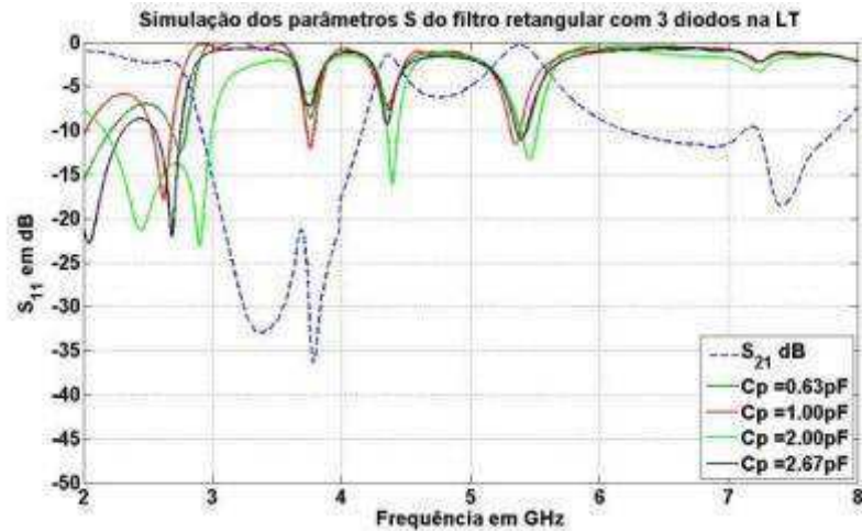
Figura 65 – Resposta em frequência do modelo 3 para o filtro retangular.
