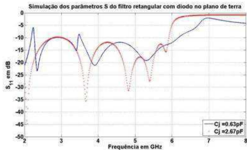
Figura 53 – Resposta em frequência do modelo 1 para o filtro retangular.
