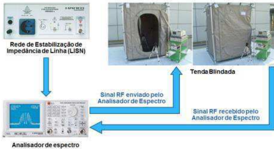
Figura 35 – Posicionamento dos equipamentos para medição utilizando TB e LISN.
