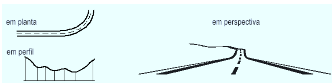
FIGURA D.13 – Defeitos em traçados: ondulações na curva (Fonte: DER/SC DCE-C, 1999).
