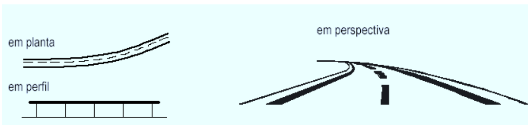
FIGURA D.07 – Pista sem dobra ótica (Fonte: DER/SC DCE-T, 1993).
