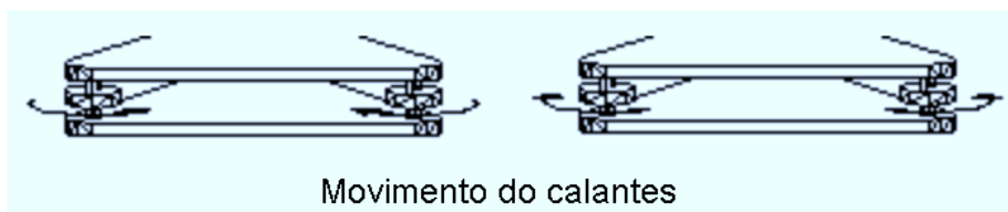
FIGURA B.27 – Método do calante perpendicular (Fonte: Escola Técnica Federal de Santa Catarina).
