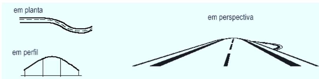
FIGURA D.18 – Defeitos em traçados: início da curva horizontal na área convexa (Fonte: DER/SC DCE-C, 1999).
