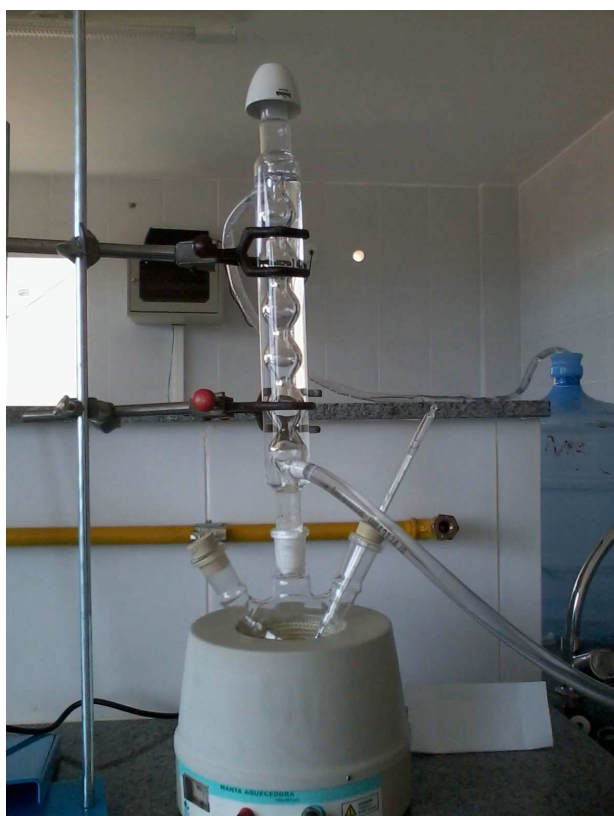
Figura 1. Sistema utilizado para modificação da vermiculita sódica por tratamento químico.
