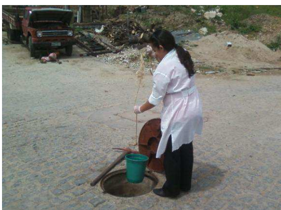
Figura 4.11 – Coleta de esgoto bruto no ponto P4, bairros Glória I e II, Jd. América e Belo Monte.
