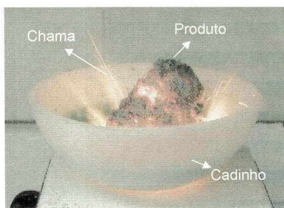
Figura 2: Reação de combustão para o espinélio \text{NiAl}_2\text{O}_4 usando uréia como combustível.
