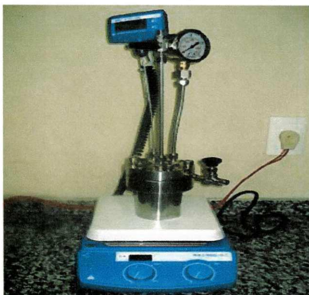
Figura 14 - Reator de aço inox de alta pressão utilizado nas reações de esterificação.
