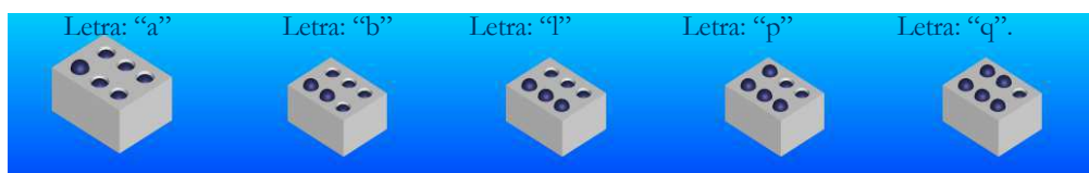
Figura 4.3.3- Estruturação dos pinos para criação de caracteres Braille.
