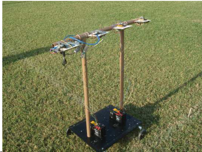
Figura 15: Barra de medição com múltiplos nós, para caracterização do ambiente.
