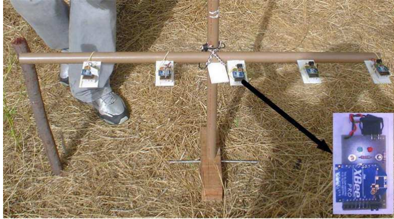
Figure 20: Estrutura montada para o conjunto de nós transmissores.
