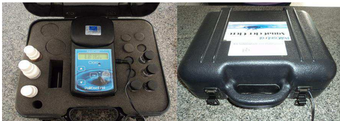
Figura 3.9 – Colorímetro para medição de cloro
