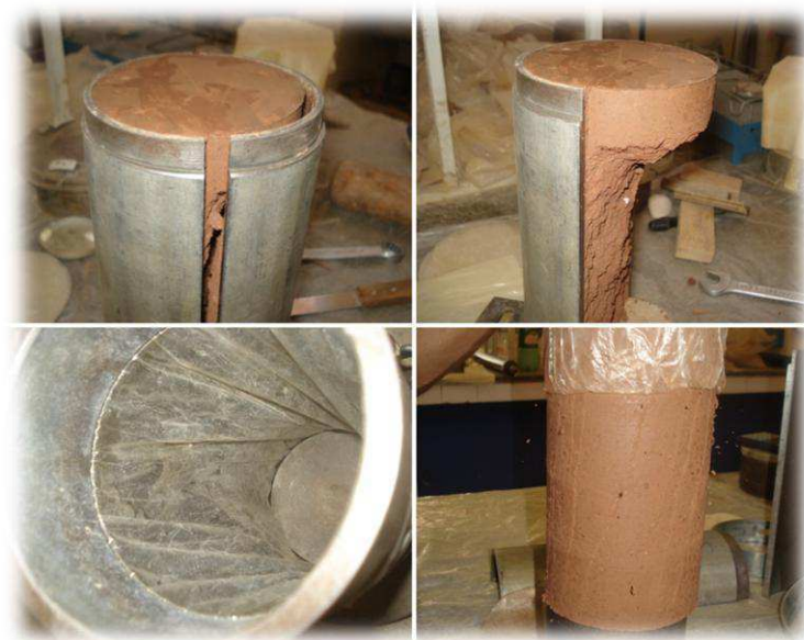
Figura 4.20 – Rompimento dos corpos de prova durante a fase de preparação para o ensaio de Módulo de Resiliência
