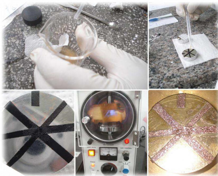
Figura 3.10 – Preparação da amostra – metalização à ouro
