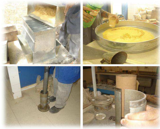
Figura 3.15 – Módulo de Resiliência – preparação da amostra - UFS
