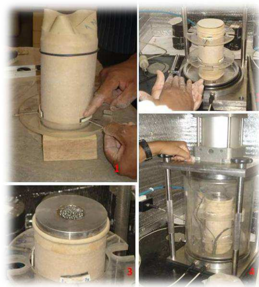
Figura 3.16 – Módulo de Resiliência –preparação e execução do ensaio - UFS
