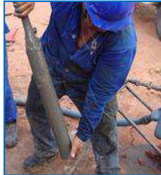
Figura 3.15 - Retirada do amostrador Shelby.
