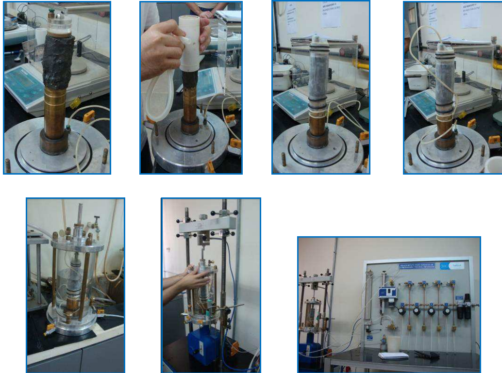
Figura 3.20 – Etapas da montagem do ensaio triaxial
