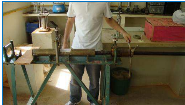
Figura 3.18 – Retirada da amostra do amostrador Shelby.
