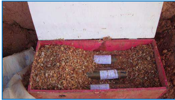
Figura 3.17 – Colocação dos amostradores em caixa com serragem.
