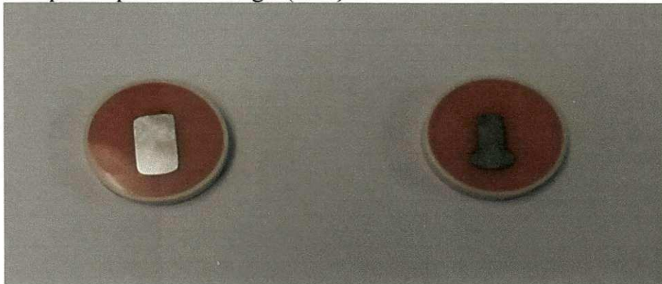
Figura 3.5 Corpos de prova que foram utilizados nas análises de Microscopia óptica e na Microanálise por Dispersão de Energia (EDS)
