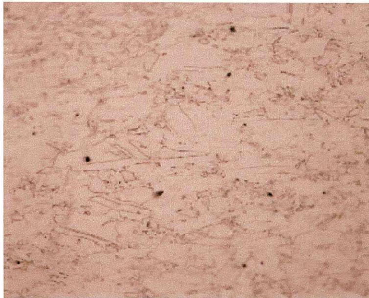
Figura 4.3 Micrografia da liga de aço inoxidável em escala de aumento de 200x
