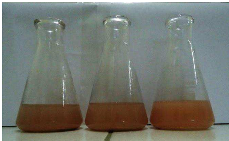
Figura 15: Titulação com \text{AgNO}_3 0,1 mol.L -1 .
