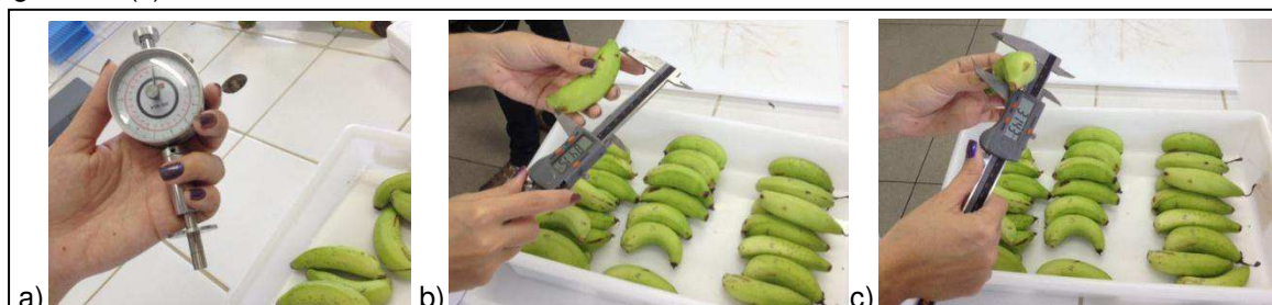
Figura 5 – Penetrômetro Instrutherm ® com ponteira de 7,9 mm (a); Medição do comprimento utilizando paquímetro digital Digimess ® (b); Medição do diâmetro utilizando paquímetro digital Digimess ® (c).
