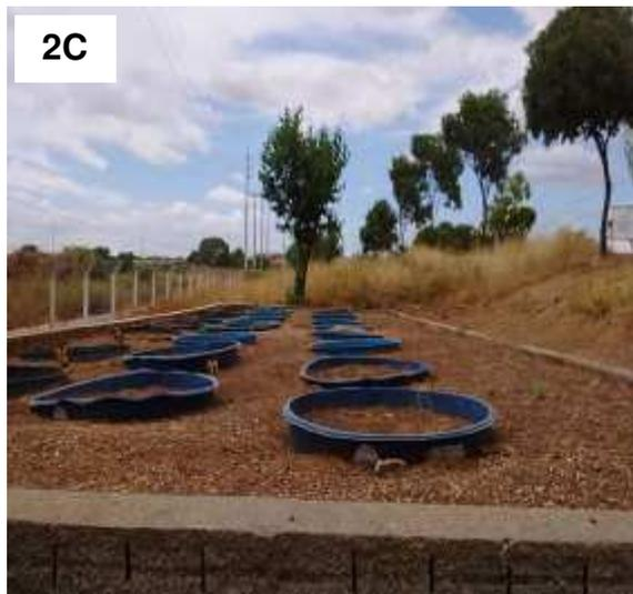
2C - disposição dos lisímetros na base de alvenaria;
