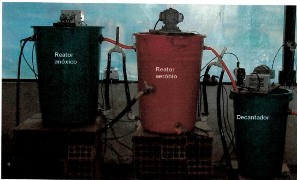
Figura 3.2: Foto do sistema de LA onde se vê o reator anóxico e aeróbio seguidos do decantador.
