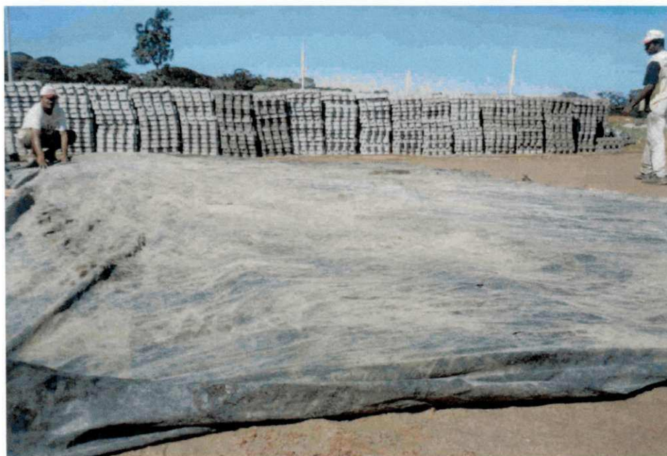
FIGURA 15 – Cobertura com lona plástica das peças verdes para cura
