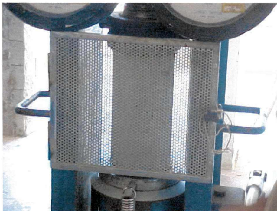
FIGURA 20 – Ensaio de compressão simples em uma presa hidráulica
