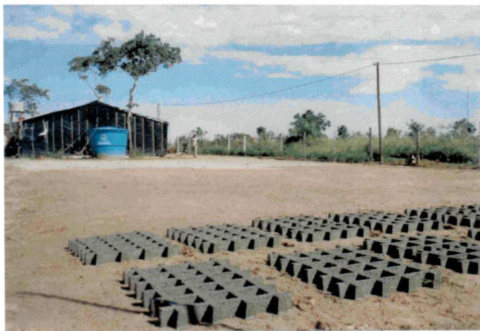
FIGURA 9 – Campo preparado para desforma das peças
