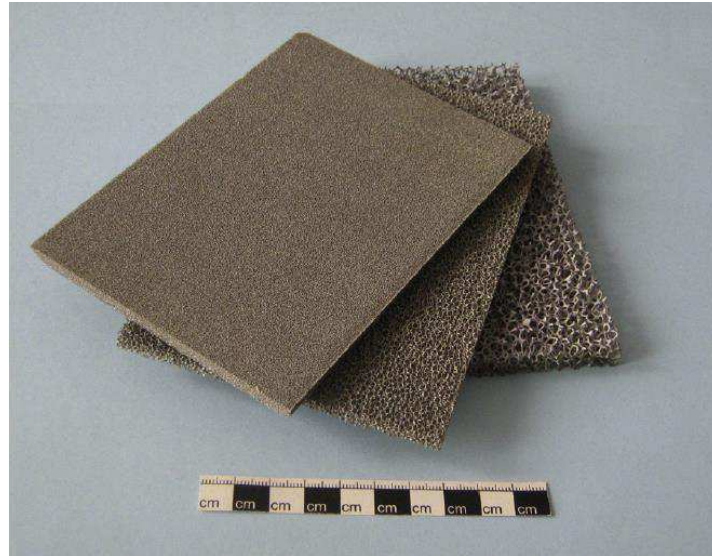
Figura 17 – Espumas de níquel, com porosidade variada, produzidas por deposição em espuma polimérica.
