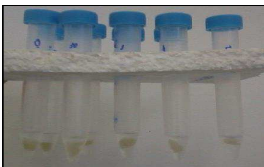
Figura 19: Tubos com o organo-gel a base de quitosana imersos em hexano, para o ensaio de estabilidade térmica.
