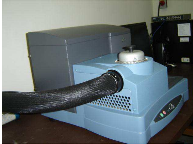
Figura 15. Equipamento DSC para determinação da temperatura de transformação de fase dos fios de LMF
