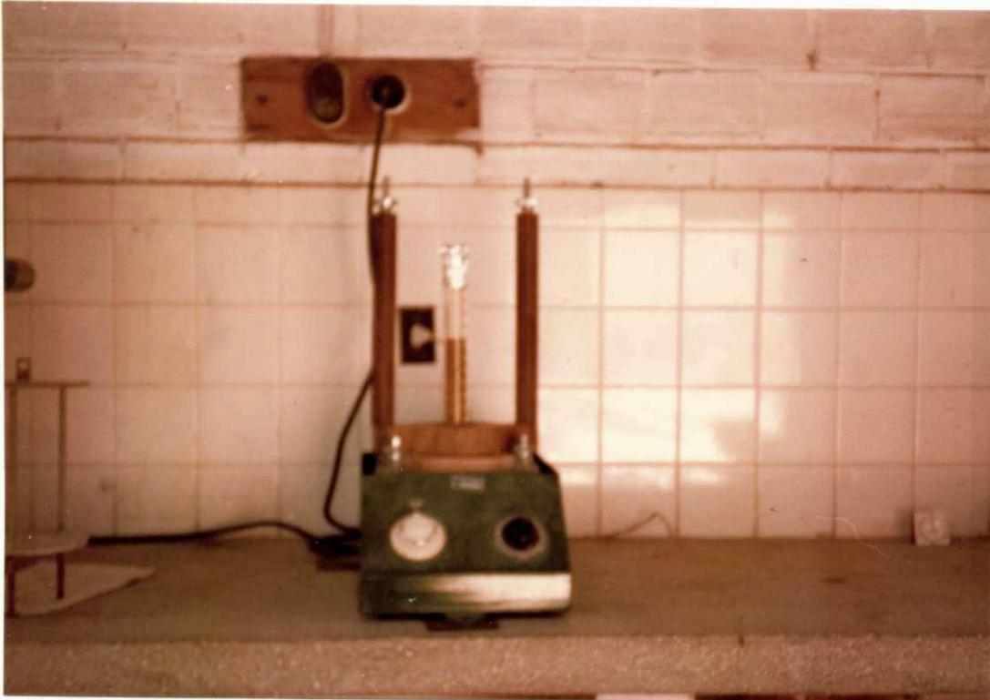
Figura 3 - Equipamento utilizado na medição da massa específica aparente
