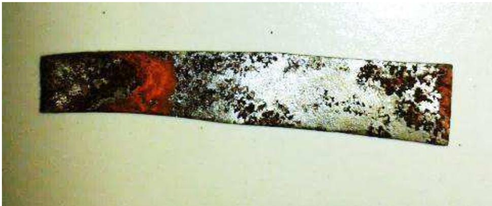
Figura 19: Chapa de ferro oxidada antes da imersão na solução do macerado a 10% de folhas de umbu.
