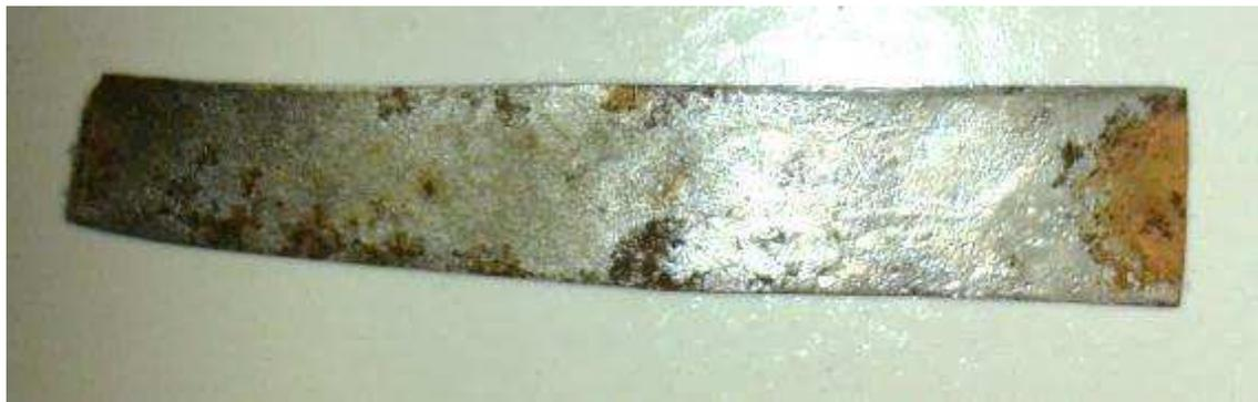
Figura 21: Chapa de ferro após imersão na solução do macerado a 10% de folhas de umbu por 10 minutos.
