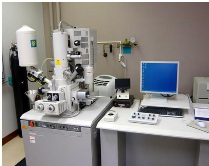
Figura 23: Microscópio eletrônico de varredura.
