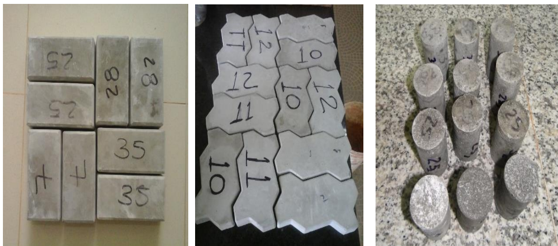
Figura 21: (a) Peças prismáticas. (b) Peças de 16 faces. (c) Corpos de prova cilíndricos.
