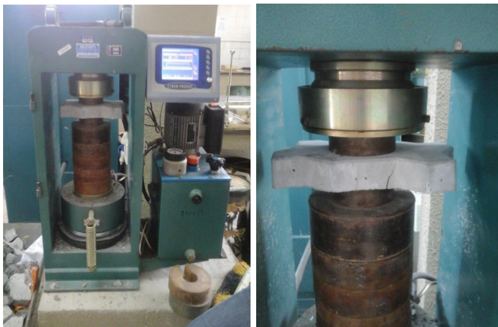
Figura 22: Ensaio de resistência à compressão.
