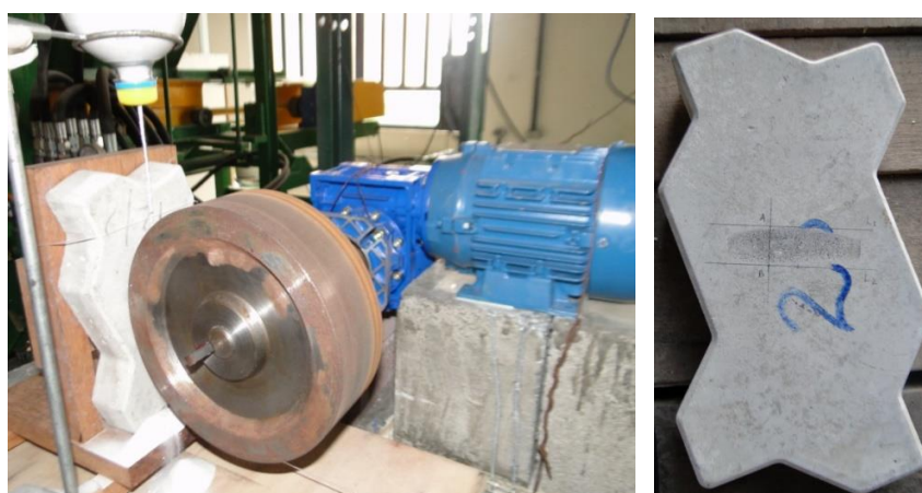
Figura 29: (a) Ensaio de desgaste por abrasão. (b) Peça desgastada pelo ensaio de abrasão. LCC/UFPE.
