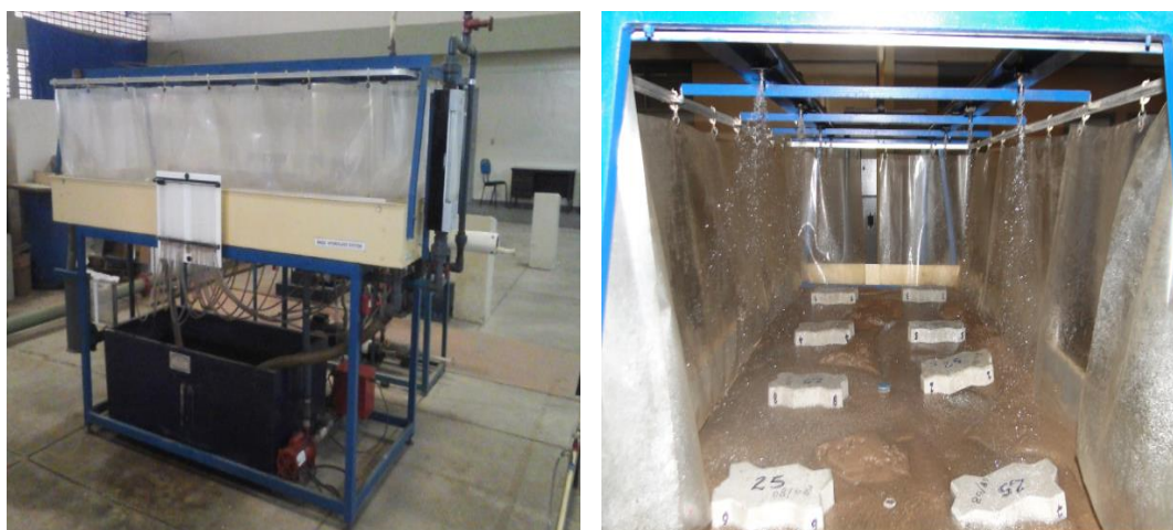
Figura 32: Ensaio de simulação de chuva.
