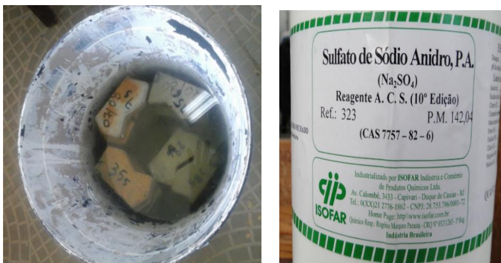
Figura 30: Ensaio de resistência ao ataque por sulfato.
