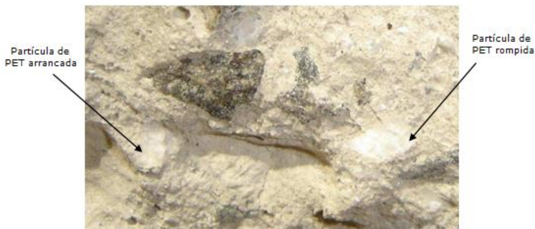
Figura 46: Corpo de prova com 10,0% de PET.
