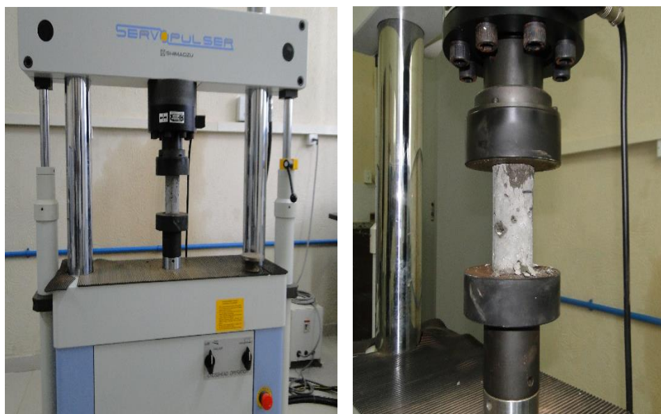
Figura 25: Ensaio para determinação do módulo de elasticidade.
