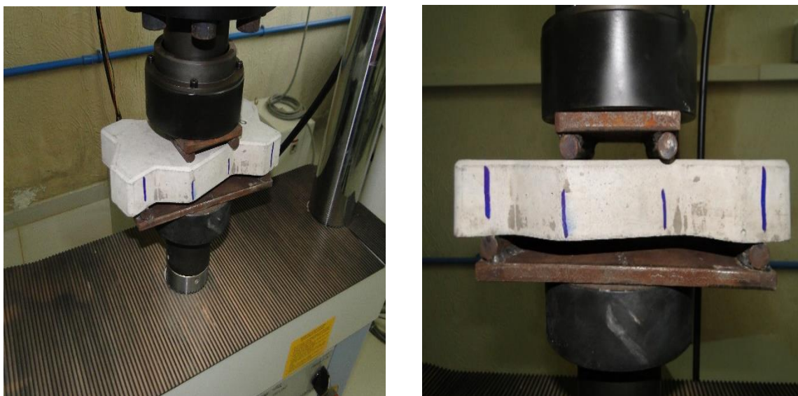
Figura 27: Ensaio de resistência à tração na flexão com peça de 16 faces.
