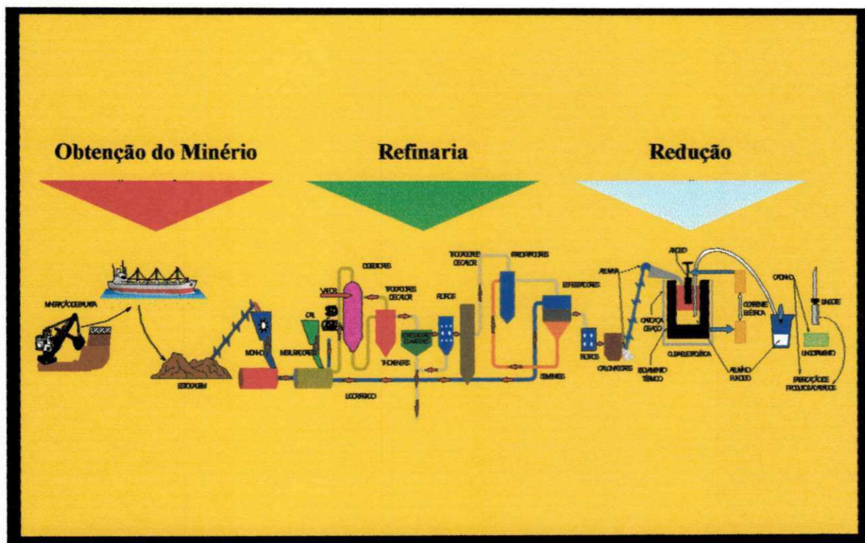
FIGURA 8 – ESQUEMA DO PROCESSO DE PRODUÇÃO DE ALUMINA E ALUMÍNIO (ALUMAR, 2001)
