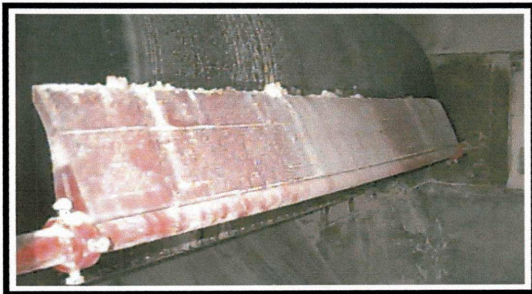
FIGURA 19 – DETALHE DE UM RASPADOR DE CORREIA (ALUMAR, 2001)
