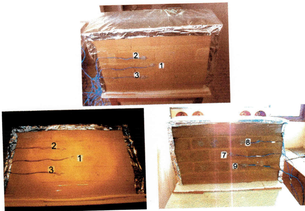
FIGURA 3.13 - Instrumentação para teste de comportamento térmico nas paredes em série
