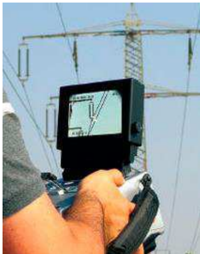
Figura 1 - Uso da câmera detectora de ultravioleta na inspeção de isoladores.
