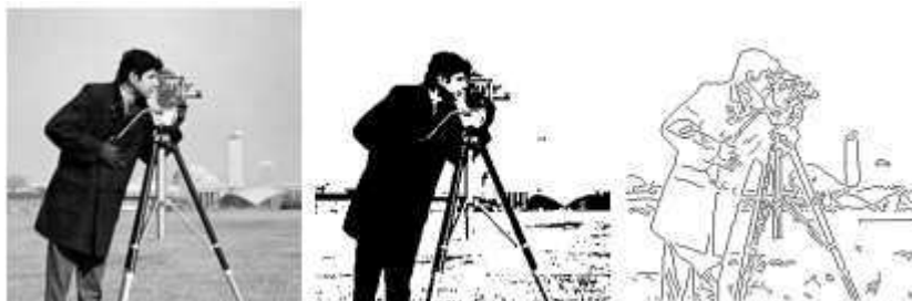
Figura 17 - Aplicação da segmentação: (a) Imagem original em níveis de cinza, (b) Imagem segmentada através de uma binarização e (c) Imagem segmentada por detecção de bordas.
