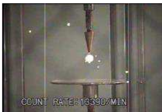
Figura 14 - Ocorrência do efeito corona em um eletrodo ponta-plano.
