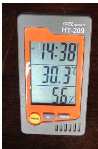
Figura 32 - Termohigrômetro utilizado para medição da umidade e temperatura.
