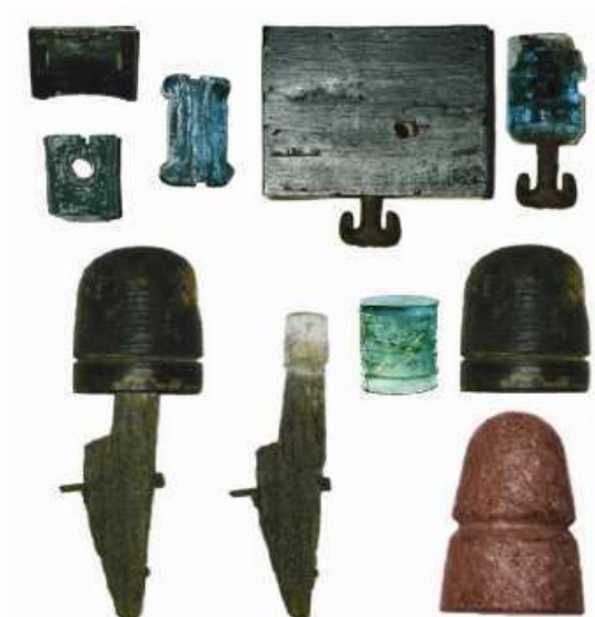
Figura 2.2 Modelos antigos de isoladores cerâmicos (JANSSEN, 2005)
