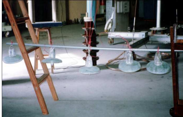
Figura 4.1. Secagem dos isoladores após aplicação artificial dos cinco níveis de poluentes
