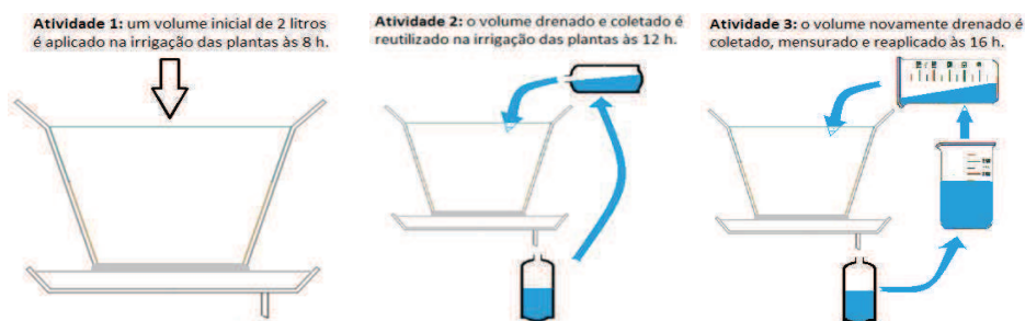
Figura 1. Manejo da irrigação do sistema semi-hidropônico utilizado
