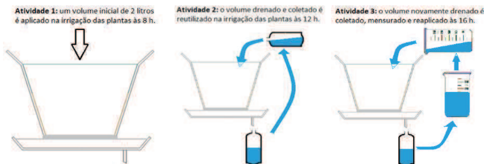
Figura 1. Unidade experimental e manejo da irrigação do sistema hidropônico utilizado
