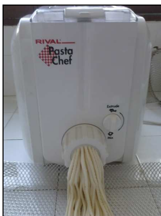
Figura 3.5 - Processo de extrusão de massas alimentícias
