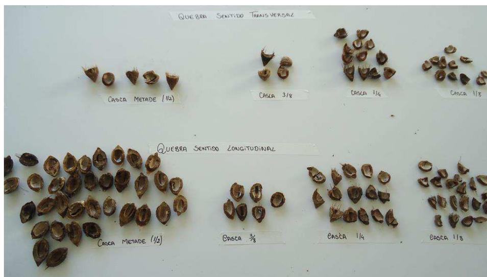
**Figura 8:** Fragmentos de casca obtidos após a quebra manual do coco catolé
