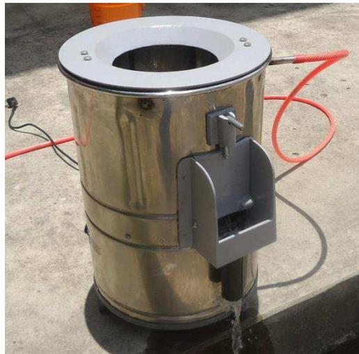
**Figura 30:** Equipamento de limpeza e despeliculagem
