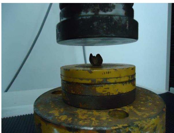
**Figura 41:** Ensaio de compressão de coco catolé
