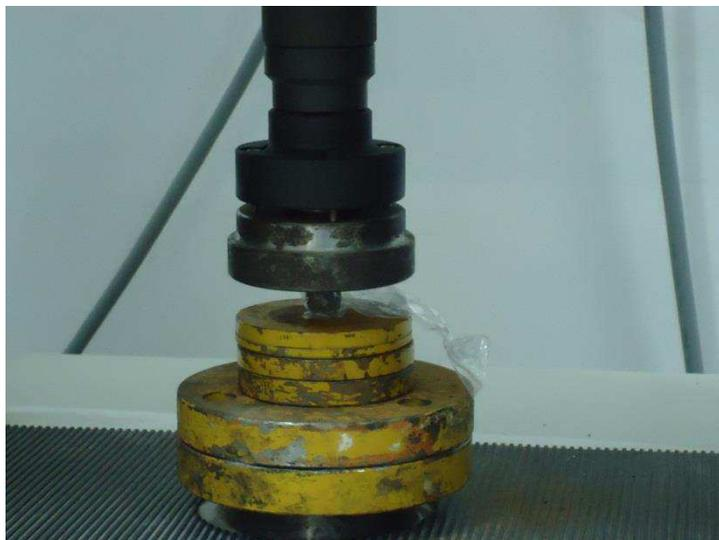
**Figura 19:** Ensaio de compressão
