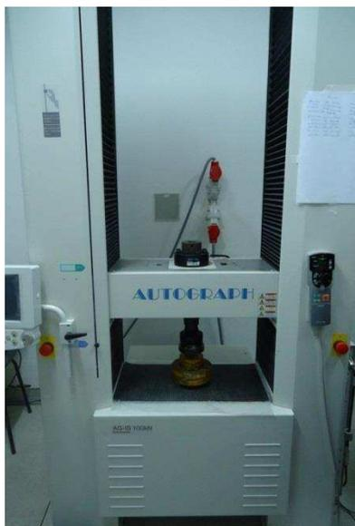
**Figura 18:** Máquina Universal de Ensaio - Shimadzu
