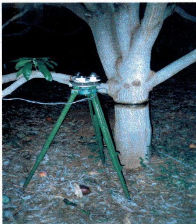
Figura 11. Radiômetros para medida da radiação global, visível e infravermelha sob copa.
