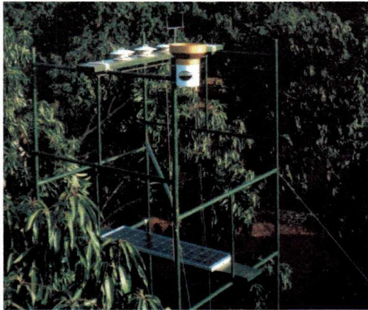
Figura 15. Torre com instrumentos para medida dos elementos meteorológicos.
