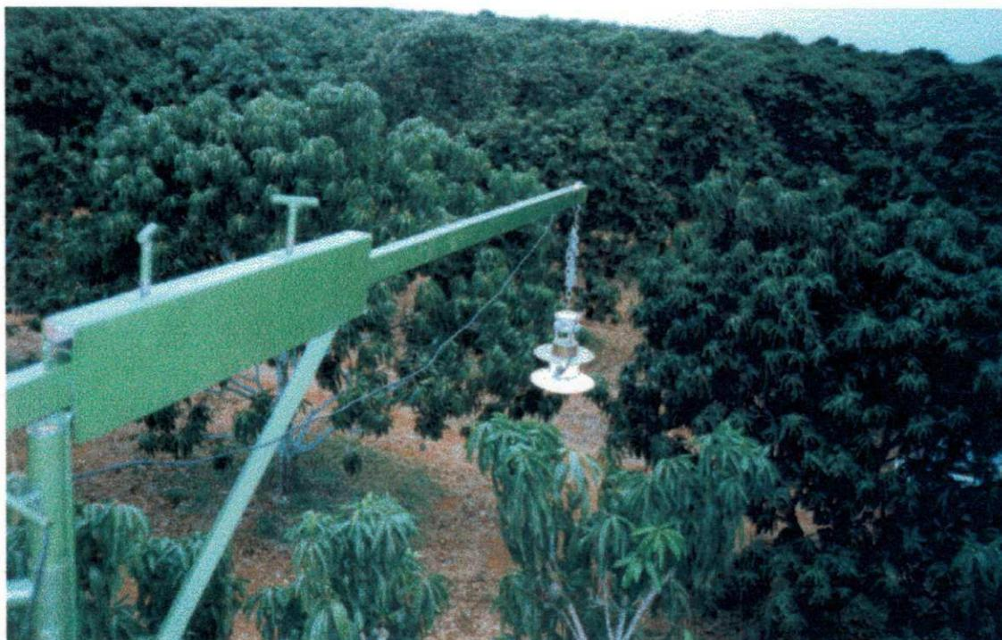
Figura 07. Estrutura com Piranômetro Eppley (PSP) para medida da radiação refletida.
