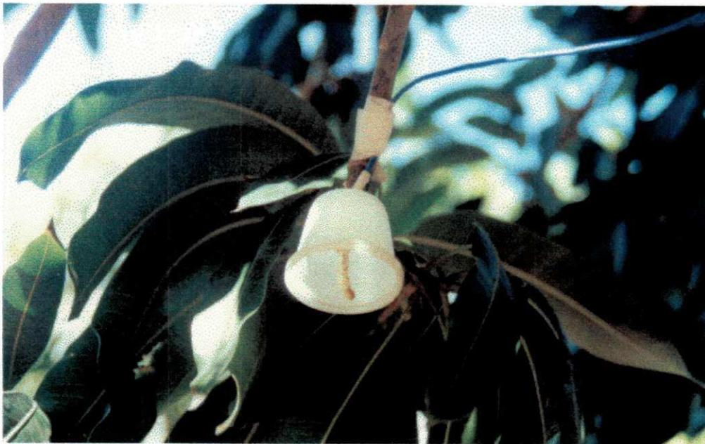
Figura 13. Sensor de temperatura do ar próximo aos frutos.
