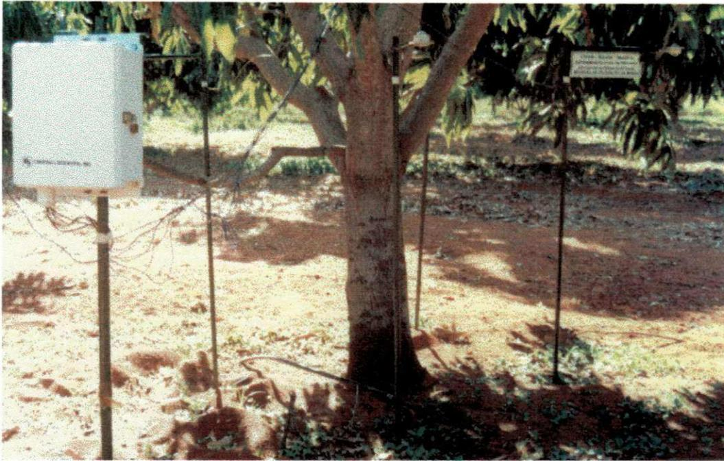
Figura 09. Distribuição dos radiômetros sob a copa da mangueira para medida da radiação global incidente.
