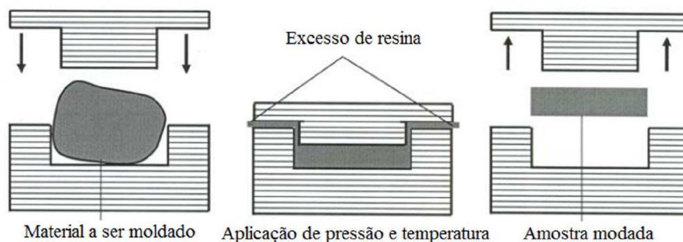
Figura 2.4 – Esquema da moldagem por compressão. Fonte: RATNA (2009)
