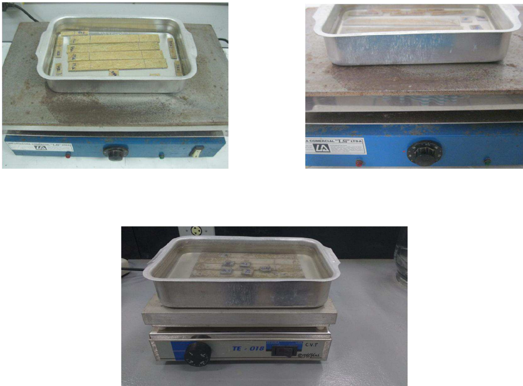
Figura 3.12 – Amostras no interior do banho térmico durante ensaio de sorção de água
