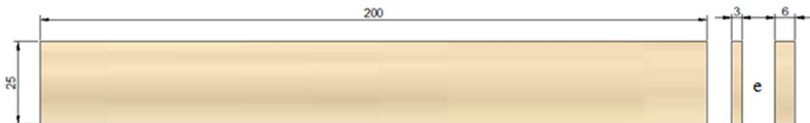
Figura 3.8 – Dimensões (mm) dos corpos de prova de tração
